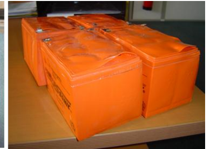
Etat de batteries Plomb Acide après emballage thermique
