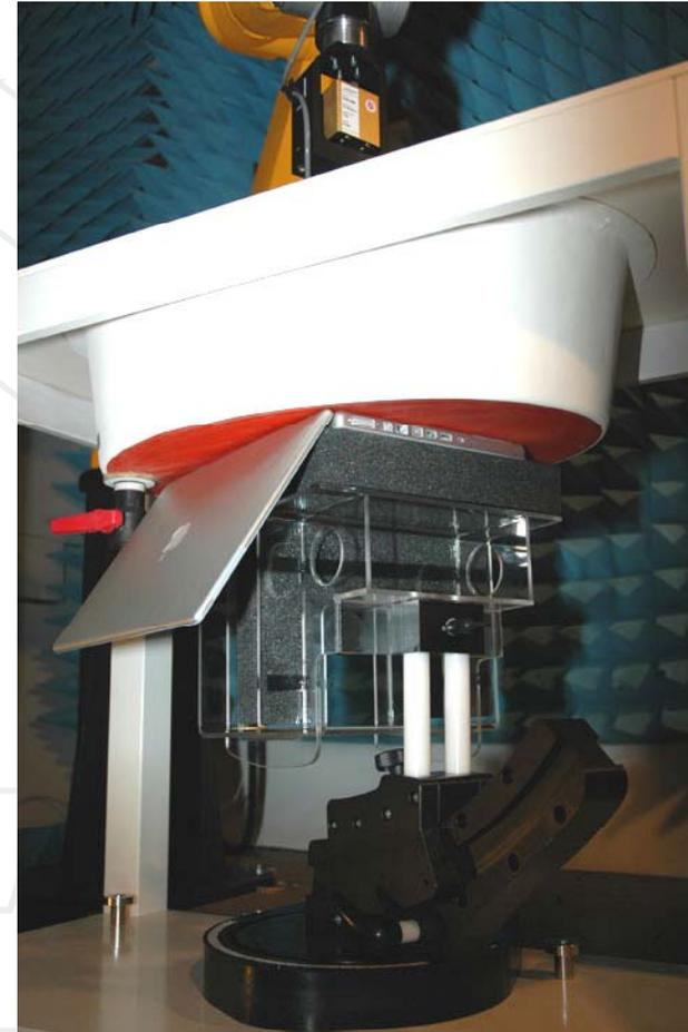
□ **Le système de mesure DAS SPEAG DASY4**
